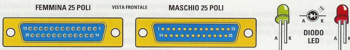
Fig.8 Connessioni viste di fronte dei connettori a 25 poli femmina e maschio. Il connettore femmina va collegato alla periferica e il connettore maschio alla porta parallela del computer. Il terminale più lungo dei diodi led è sempre il terminale Anodo.
