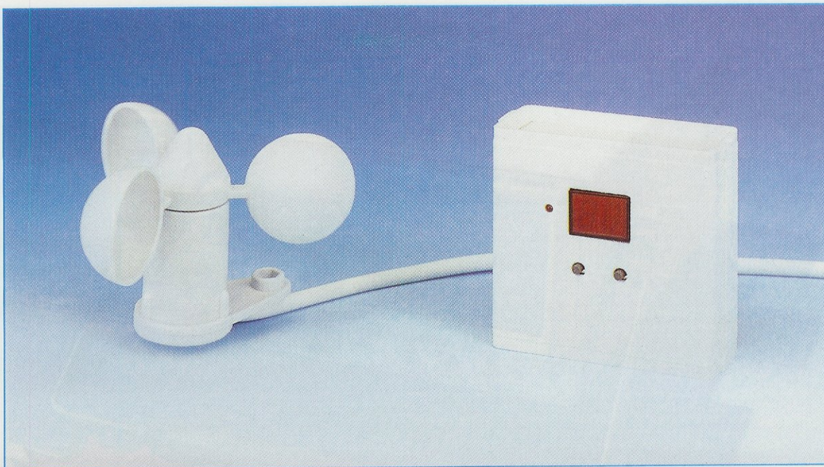
Fig.10 Foto dell'Anemometro posto vicino al mobiletto contenente il circuito elettronico. E' sottinteso che l'Anemometro va collocato sul tetto della casa per poi scendere con un cavetto a due fili fino al mobiletto del Display. Se non potete collocarlo sul tetto, fissatelo in un terrazzo tenendolo distanziato dal muro della casa.
