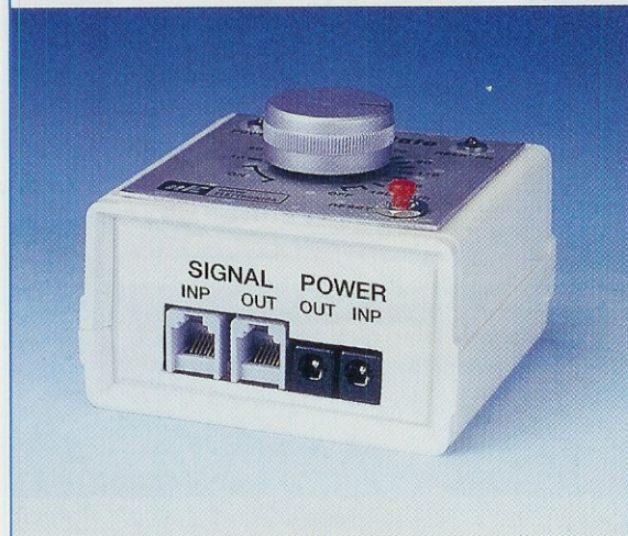
Fig.9 Foto del pannello frontale dal quale fuoriescono i connettori plug per i collegamenti con l'anemometro e la centralina e le due prese di alimentazione polarizzate.
