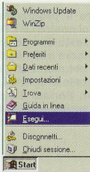
Fig.13 Per installare il programma LPT Tester per la gestione della parallela, dovete cliccare sul tasto Start e poi sul tasto Esegui.
