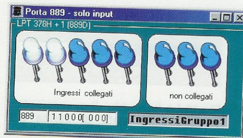
Fig.22 Come si presenta la finestra principale del programma LPTTester. A sinistra abbiamo riprodotto lo stampato con i diodi led e a destra i dip switch corrispondenti ai segnali del gruppo 0 e del gruppo 2. Spostando i dip switch potete simulare gli stati logici 1 e 0 sulle uscite della linea parallela.
