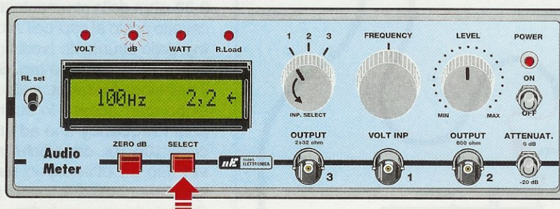
Fig.22 Premendo il pulsante Select per 1 secondo riuscirete a far accendere il Diode Led dei dB e vedrete così apparire sul Display un numero seguito da una "freccia". Se ora premete il pulsante "Zero dB" per circa 1 secondo, apparirà il valore 0,0 dB.
